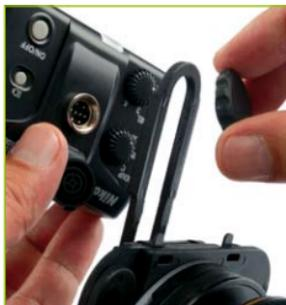
Fissare al supporto con il pomello filettato in dotazione.
