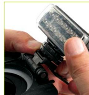
Sostituire i braccetti per alloggiamento flash con quelli con slitta porta accessori. Fissare gli illuminatori LED ed orientarli secondo le esigenze.
